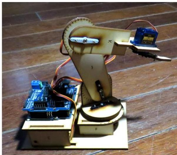
(圖一) 完全自製機械手臂教具
