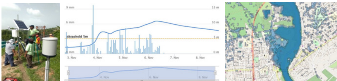
圖 4-86「貝里斯城市韌性防災計畫」於 San Ignacio 市區架設水文氣象測站即時監控水位以及天候的變化，並建置預警系統平台成功預測淹水範圍
