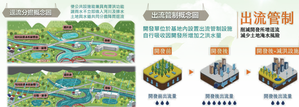
圖 4-12 逕流分擔及出流管制概念圖
